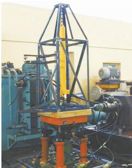
图 11 实验室的小型液压振动台,正在对黄色的悬挂都柱进行测试
