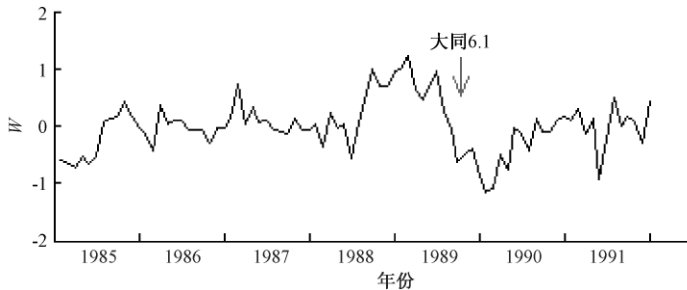
图3 大同地震前后断层垂直形变速率综合指标随时间变化
